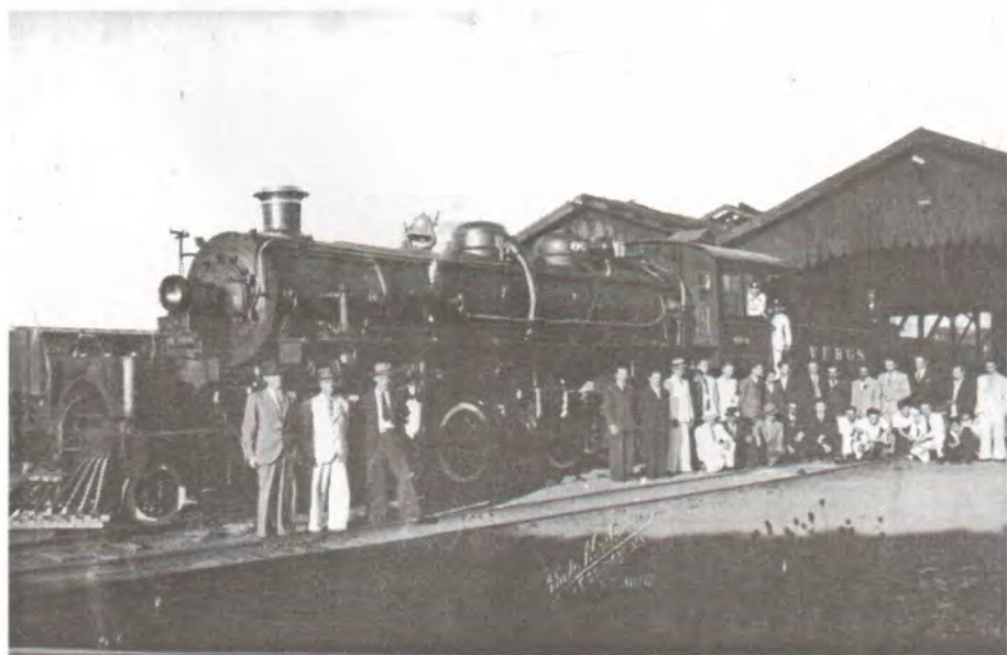
Locomotiva MALET – Trabalha com vapor saturado, alto e baixo. Grande capacidade de tração
