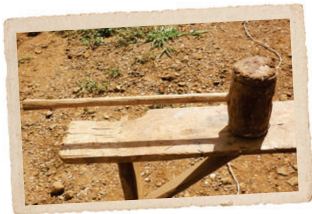
MALHO DE MADEIRA (MAZZA) O malho de madeira era utilizado para bater em cunhas de madeira (ferro) para lascas toras de madeira.
