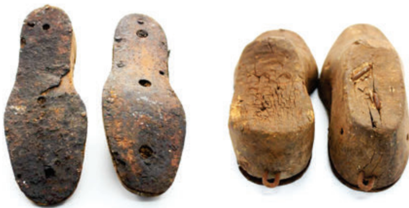
FORMAS PARA SAPATOS Os calçados eram fabricados a partir de formas de madeira.
