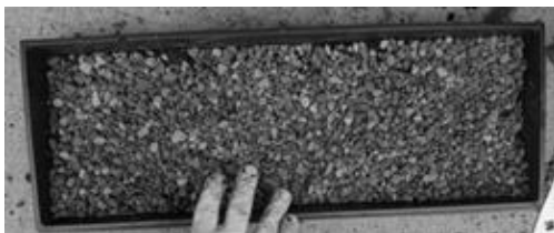
Figura 1.3 Primeira camada acima do solo, pedras para dar maior permeabilidade.
