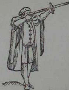
Fig. 21. Observação da Polar com a balestilha.
